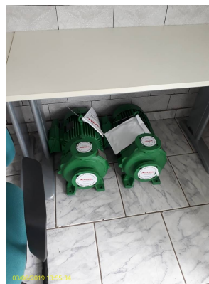
Foto 2 - Conjunto motobomba para substituição nas ERAT's
